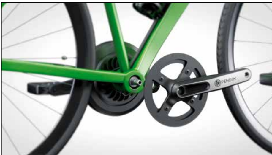
▲ E-Bike-Sensoren der NCTE machen den Nachrüstantrieb Pendix eDrive smart. Bild: Pendix
